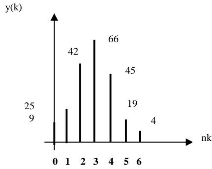
Figure 3 : le produit de convolution des signaux discret  $f_1(n)$  et  $f_2(n)$ .
