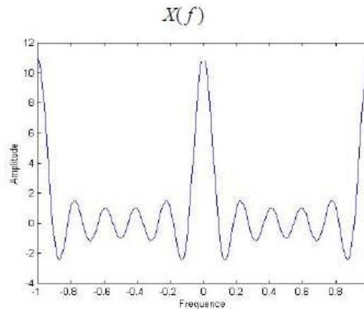
Figure (7) : Spectre du signal rectangulaire discret.
