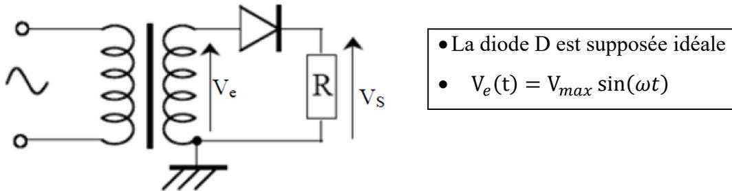
Figure 1 Schéma d'un circuit redresseur simple alternance.
